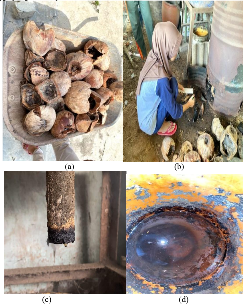
Gambar 2. Tahapan proses produksi biopestisida asap cair berbahan baku sabut kelapa: (a) bahan baku sabut kelapa; (b) proses pirolisis dalam reaktor; (c) kondensasi asap menjadi cairan; (d) produk asap cair hasil kondensasi.
