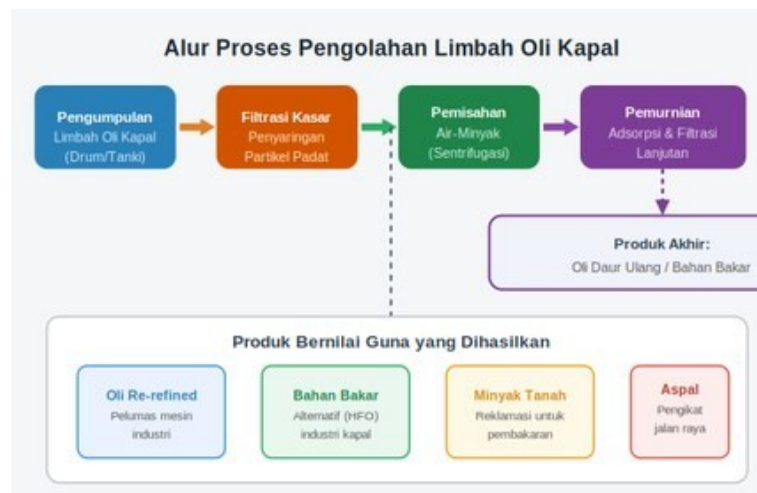
Gambar 3. Diagram Alur Proses Pengolahan Limbah Oli Kapal Menjadi Produk Bernilai Guna
